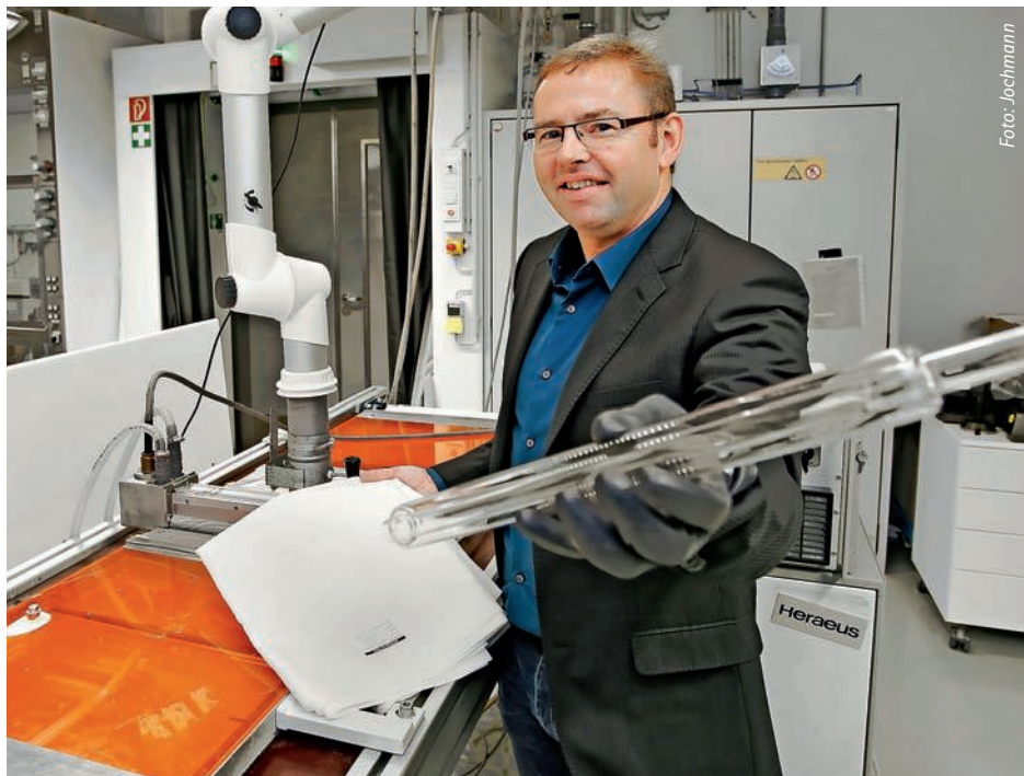
Dr. Klaus Opwis steht hinter der Speziallampe, mit der die Katalysatoren photochemisch am Textil befestigt werden.
