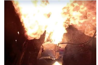
Explosion während eines Thermal Runaway einer Lithium-Ionen-Pouchzelle.
