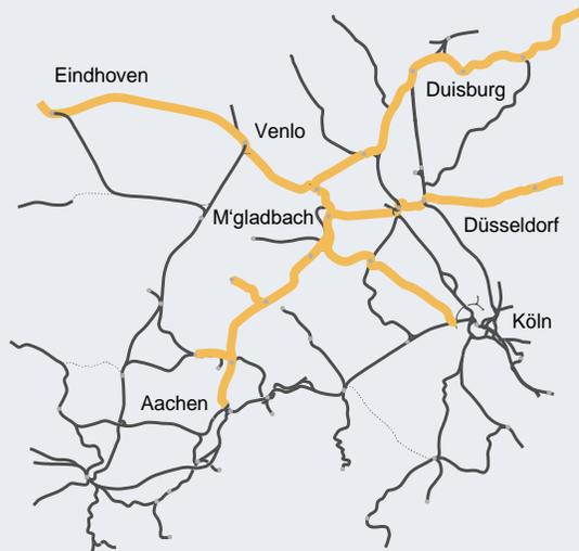
Herstellung eines Halbstundentakts aus RE4 und RE42 auf Achse Mönchengladbach–Aachen sollte bei Überplanung der Achse und Drehung RE4/RE13 ohne weiteren Infrastrukturmaßnahmen möglich sein.
